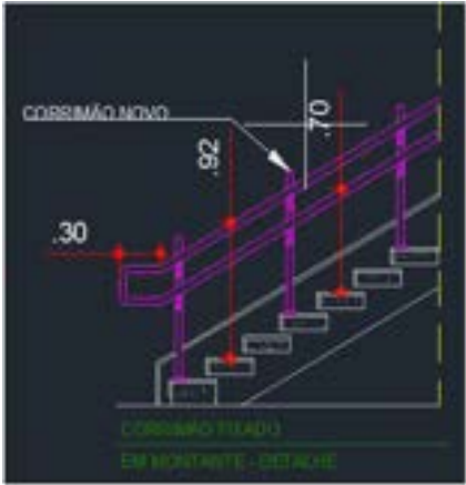
PROJETO DO GUARDA-CORPO NOVO COM CORRIMÃO ITEM 4.3 FIXADO NO PISO COM PARAFUSOS
