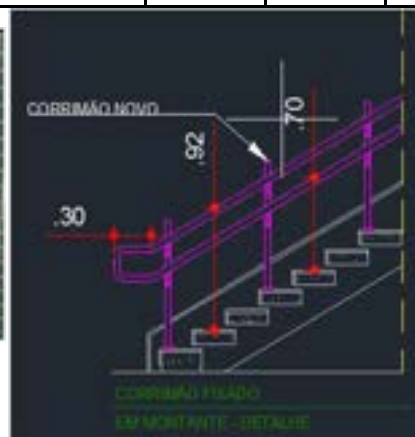
PROJETO DO GUARDA-CORPO NOVO COM CORRIMÃO ITEM 3.2 - SOLDADO NO PERFIL DA ESCADA
